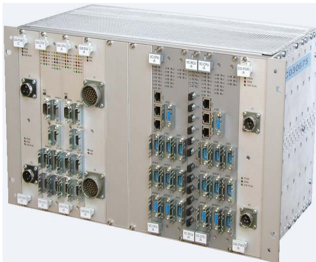
Obr. 8 - Kazeta s TCG a VCU firmy UniControls a.s., zálohované provedení
